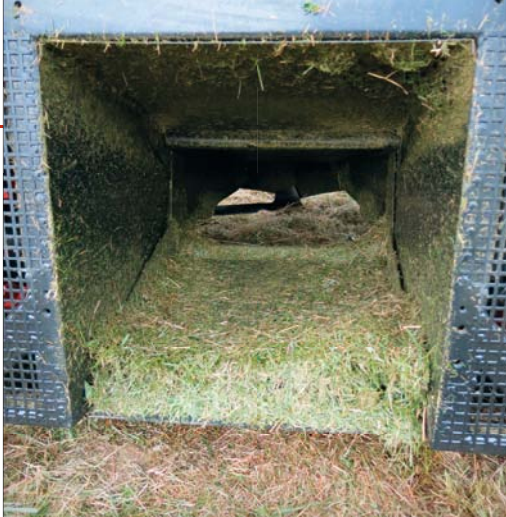
Rozměrný výhozový tunel pro bezproblémový transport trávy do koše je vybaven po celé délce čistící klapkou
