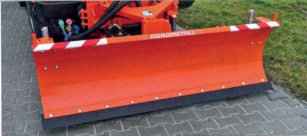
Čelně nesená odpružená sněhová radlice OR – M 130 určená pro malotraktory pracuje se záběrem 1300 mm s možností hydraulického natáčení
