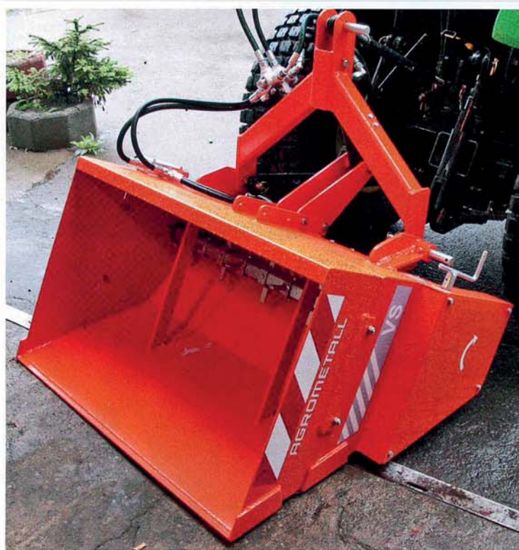
Univerzální válečkový sypač Agrometall VS pracuje jako nesený v třibodovém závěsu traktoru
