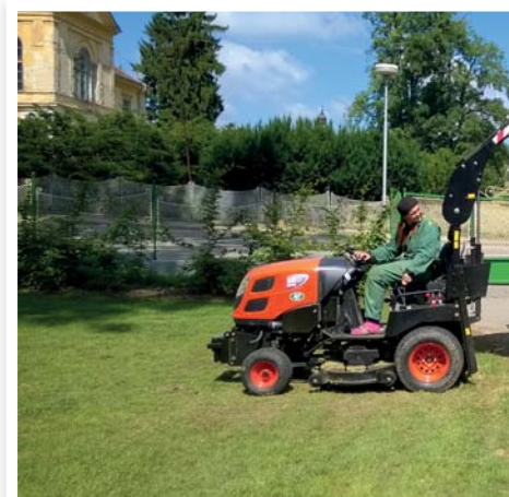
Kladem je výškový zdvih zásobníku až do 191 centimetrů
