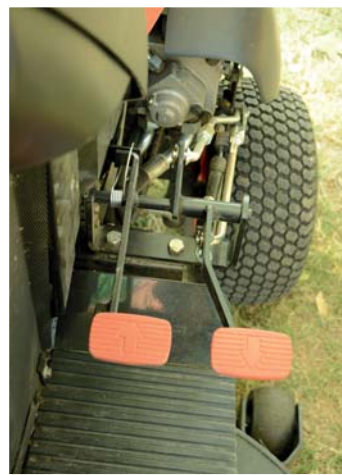
Obsluha je velmi jednoduchá a pojezd se ovládá dvěma pedály
