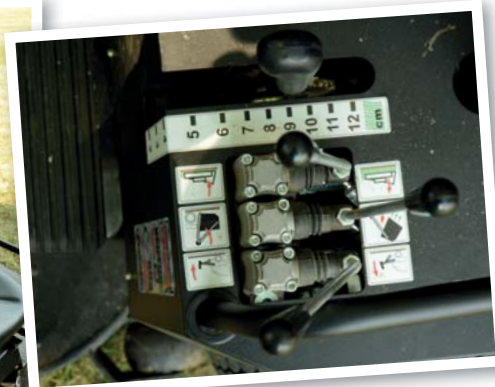
Po levé ruce obsluhy se nachází ovládání výšky sečení, vysypávání koše, čelního PTO
