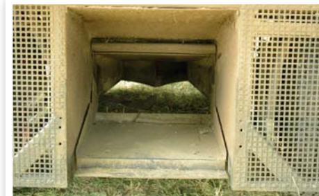
Rozeřný výhozový tunel pro bezproblémový transport trávy do koše je vybaven po celé délce čistící klapkou
