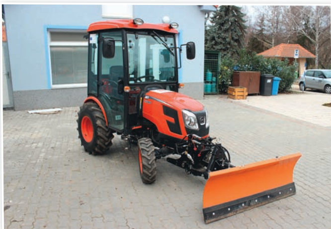
K hlavním přednostem traktoru patří výkon motoru 28 koní, moderní kapotáž a výkonná čelní hydraulika
