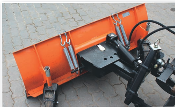
Čelní sněžová radlice s vodícími koly VARES Mnichovice pracuje se záběrem 140 cm
