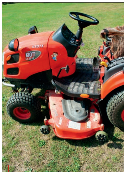
Žací ústrojí pracuje se třemi noži a záběrem 1524 mm
