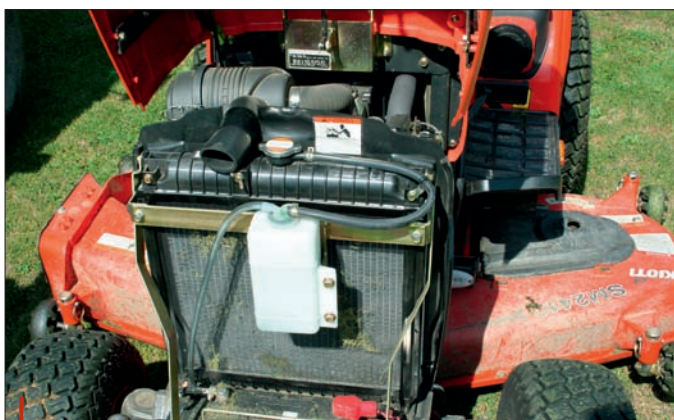
Pohonnou jednotkou je tříválcový vodou chlazený motor s výkonem 26 k
