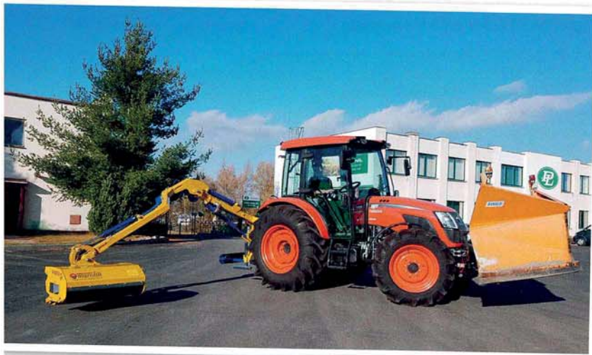
Letní a zimní varianta nasazení traktoru – v zimě pracoval s čelní sněhovou radlicí a sypačem, od jara může být agregován s příkopovým ramenem Marolin M430AX
