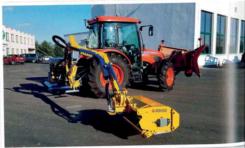
Předsunuté příkopové rameno pracuje upevněné v zadním tříbodovém závěsu, obsluha traktoru má o práci mulčovací hlavy dokonalý přehled
