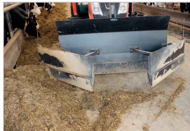
Biskupická firma P & L vyrobila ve svém středisku ve Velkém Meziříčí podle požadavků chovatelů speciální přihřnovací radlici
