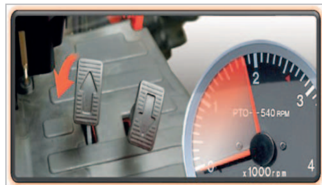
Komfortní zdvojené pedály HST mění směr a rychlost pojezdu v závislosti na otáčkách motoru
