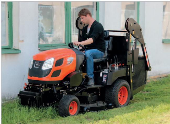
Žací traktor Kioti WD1260 pracuje se středovým tunelem a vysokovýklopným košem. Pohonnou jednotkou je motor Shibaura o výkonu 26 koní
