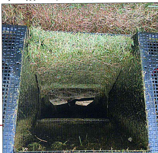
Rozměrný vyřezový tunel pro bezproblémový transport trávy do koso je vybaven po celé délce čističí klapkou
