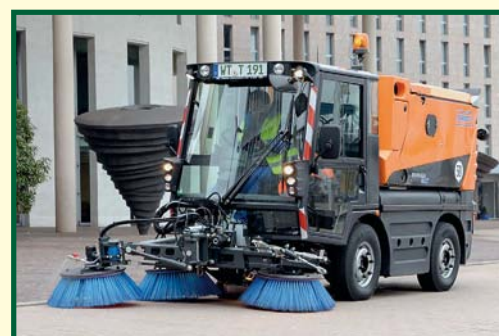
Swingo 200+ 3 kartáčový systém unikátní systém sání KOANDA se vrací
