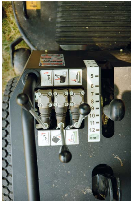
Po levé ruce obsluhy najdeme ovládání výšky sečení, čelního PTO a vysypávání koše
