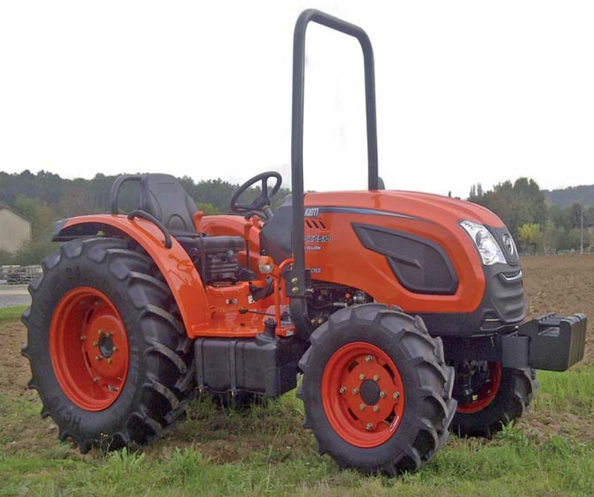
Kioti DK 5510 je osazen přeplňovaným tříválcovým motorem CRDi splňujícím emisní normu stupeň 3B
