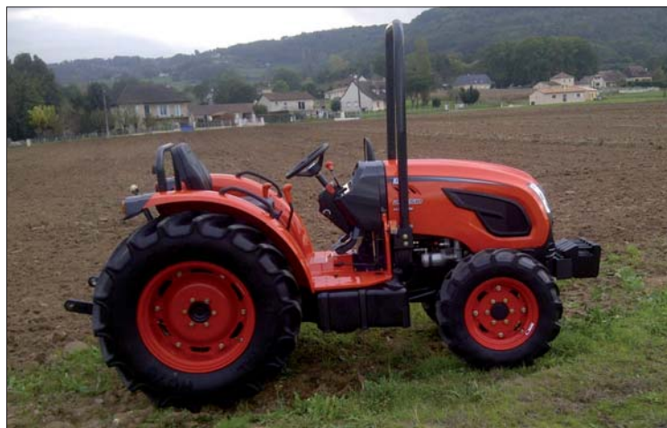
Traktory Kioti DK 4510 a 5010 jsou osazeny čtyřválcovým dieslovým motorem s atmosférickým plněním o výkonu 45 k a 49 k a objemem 2430 cm 3 , splňujícím emisní normu stupeň 3A
