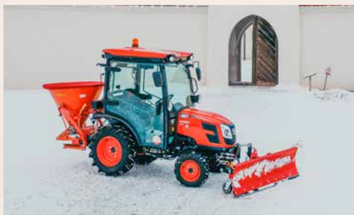
Traktor Kioti CX2510CH s čelní natáčeací radlicí 150 cm a rozmetadlem 300 l
