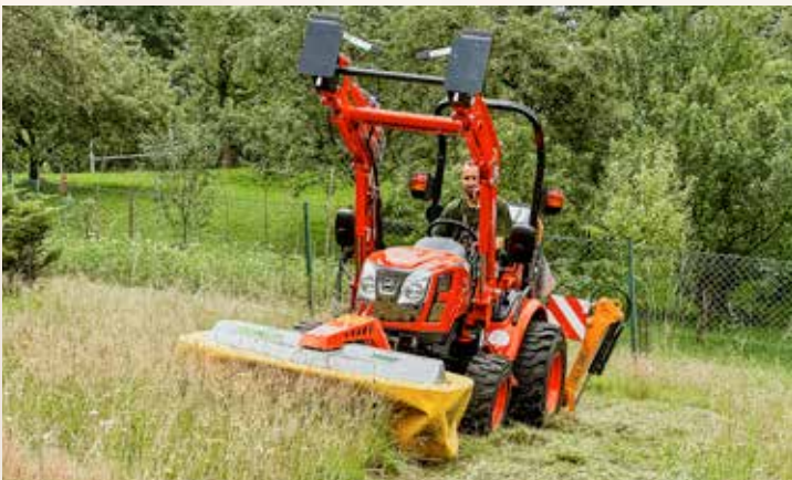
Traktor Kioti CX2510H s čelním nakladačem, čelní bubnovou sekačkou a zadním podkopem
