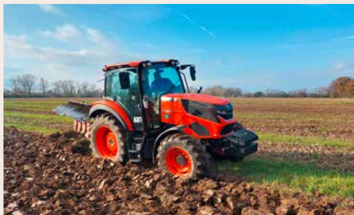
Traktor Kioti HX1201PC při orbě se 4radličným pluhem
