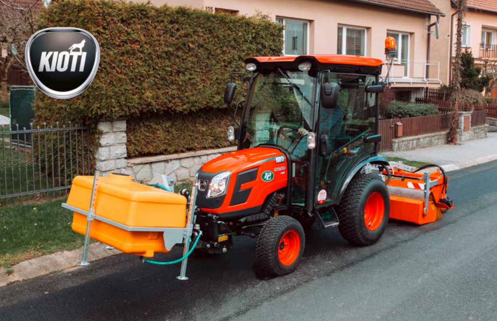
Traktor Kioti CX2510CH se zametacím kartáčem a kropením Agrometall
