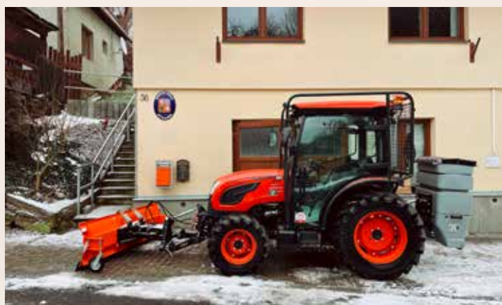
Traktor Kioti DK6020 s čelní natáčecí radlici 150 cm a rozmetadlem Hilltip 300 I
