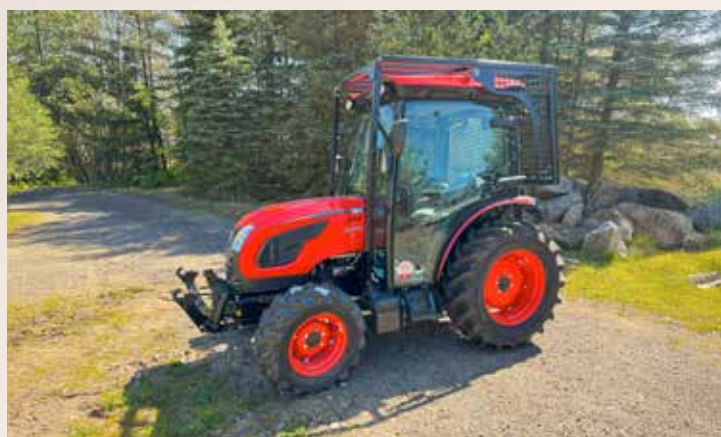
Traktor Kioti DK6020C s lesní nástavbou splňující normy OPS, FOPS
