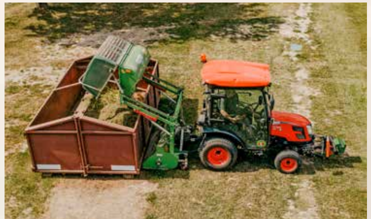
Traktor Kioti CX2510CH v agregaci s mulčovačem se sběrem Peruzzo Koala Professional 1200
