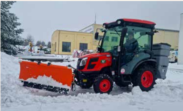
Traktor Kioti CX2510CH s čelní natáčecí radlicí a rozmetadlem Hilltip 300 I
