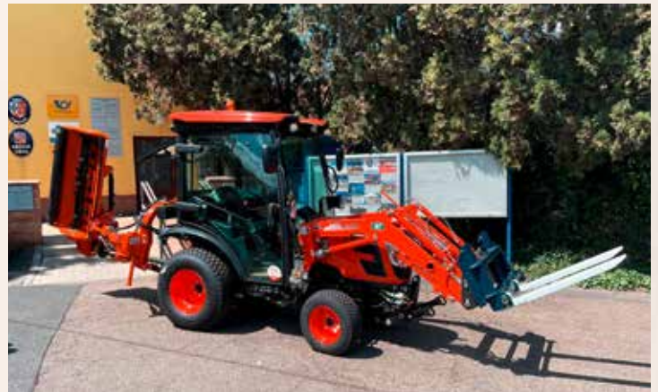
Traktor Kioti CX2510CH s čelní nakladačem, paletizačními vidlemi a mulčovačem Tierre MiniTCL120
