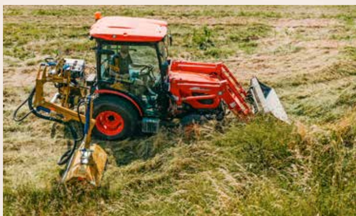
Traktor Kioti CK4030CH s čelním nakladačem a příkopovým ramenem Marolin M380 APS
