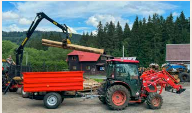
Traktor Kioti DK6020CH s čelním nakladačem a třístranně sklopným vlekem
