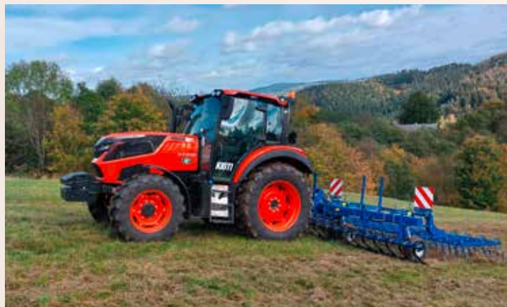
Traktor Kioti HX1201PC s lučnými bránami Kockerling Grasmaster 600
